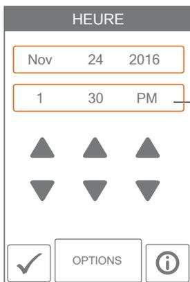
Lorsque le système est connecté au réseau Internet, l'heure peut être réglée automatiquement.
