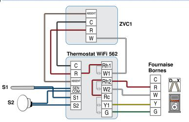
Le thermostat WiFi 562 peut faire fonctionner un plancher radiant en première phase de chauffage et un ventilo-convecteur en deuxième phase, ainsi qu'un climatiseur.
