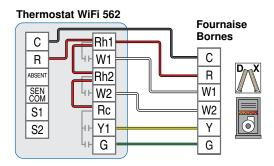
Le thermostat WiFi 562 peut faire fonctionner un plancher radiant en première phase de chauffage et une fournaise en deuxième phase, ainsi qu'un climatiseur.
