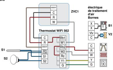
Le thermostat WiFi 562 peut faire fonctionner un radiateur ou une plinthe en première phase de chauffage et un ventilo-convecteur en deuxième phase, ainsi qu'un climatiseur.
