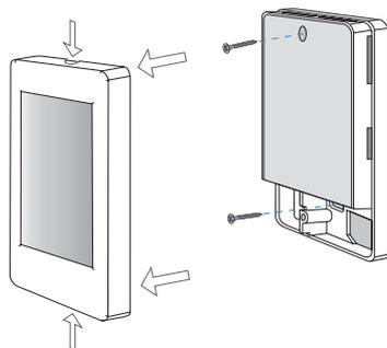
Saisissez le couvercle par les petits orifices pour ongles dans le haut et le bas du boîtier, puis retirez le couvercle.
