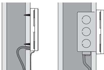
Le boîtier doit être monté à ras sur un mur ou posé sur une boîte électrique non conductrice de 5 cm x 10 cm (2 po x 4 po). Les trous de montage du boîtier sont compatibles avec des vis n° 6. Les fils électriques du dispositif de commande entrent dans le compartiment de connexion par l'arrière ou par le dessous du boîtier.
